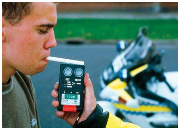
Conductor al que se le está realizando la prueba de contenido de alcohol en la sangre con un alcoholímetro manual.
